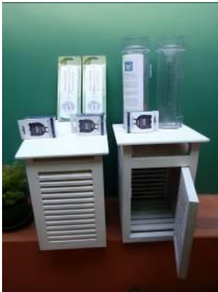
Casetas para la instalación de los instrumentos
